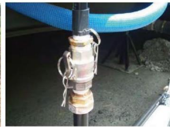
⑥給水管の接続方法が工具を使用せずに着脱出来る方式であること。
